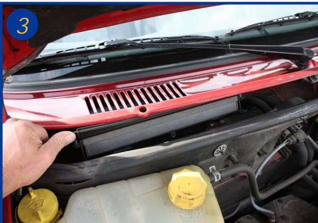
Soulever le couvercle et le maintenir soulevé afin d'extraire l'élément filtrant usagé.
