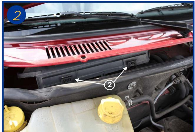
Exercez une pression vers le bas sur les 2 fermoirs du boîtier filtrant (2)
