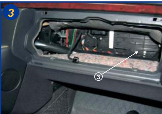
Ouvrir la trappe du boîtier filtrant à l'aide de la patte de fermeture (3) et la retirer.
