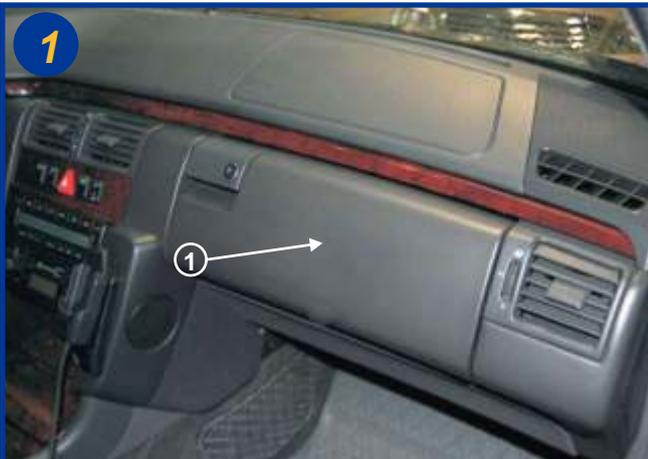
Les filtres d'habitacle sont situés à l'intérieur du véhicule, côté passager derrière la boîte à gants (1). Ouvrir la boîte à gants.
