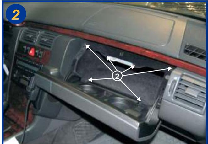
Dévisser les 6 vis cruciformes (2) et extraire la garniture de la boîte à gants. Il est également nécessaire de débrancher l'éclairage de la boîte à gants.
