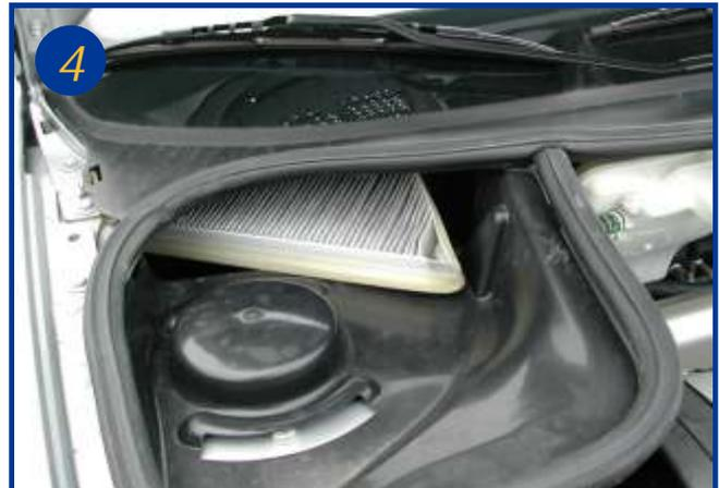
Positionner l'élément filtrant dans sa totalité au fond de sa cavité prévue à cet effet le joint en mousse vers le bas
