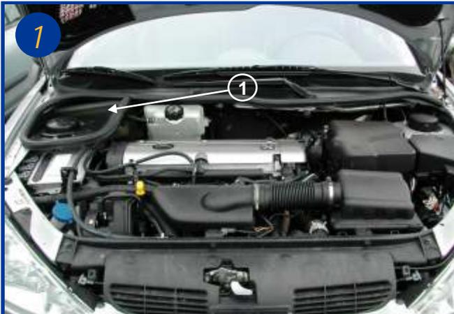
L'élément filtrant est situé sous le capot moteur près du passage d'aile coté passager (1).
