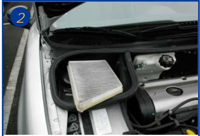
Glisser la main dans l'ouverture du conduit d'aération pour en extraire l'élément filtrant usagé
