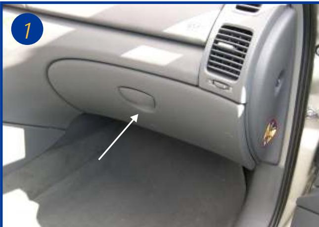
1- L'élément filtrant est situé derrière la boîte à gants dans l'habitacle du véhicule. (Voir flèche)
