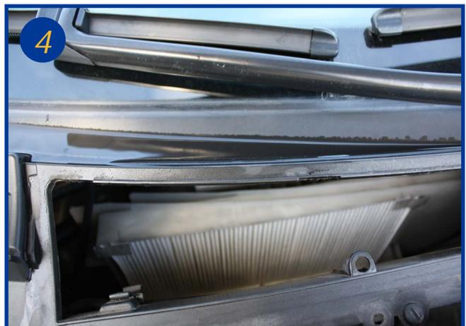
Procéder à son remplacement en imbriquant les 2 premiers plis à chaque extrémité dans les nervures à l'intérieur du boîtier. Le remontage s'effectue dans l'ordre inverse du démontage.
