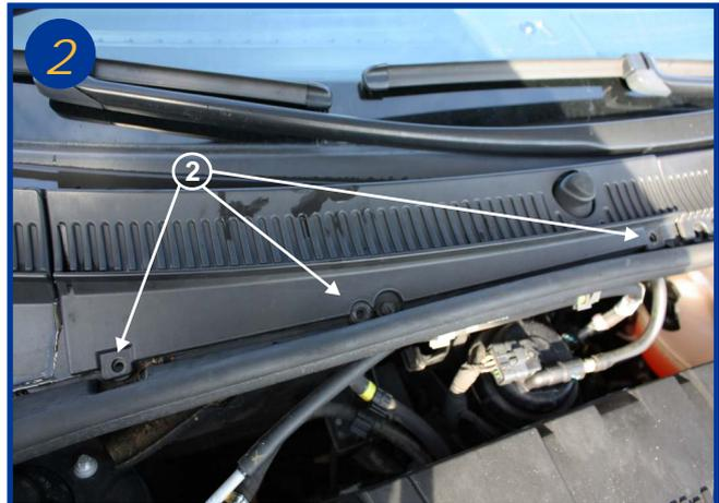
Retirer à l'aide d'un tournevis plat et en effectuant un quart de tour uniquement les 3 clips plastiques de fixation du couvercle de boîtier (2).
