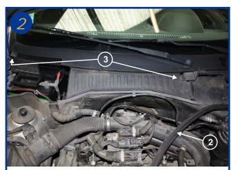
Retirer sur plus de la moitié le joint d'étanchéité (2) Dévisser les 2 vis Torx (T25) (3) et retirer le carter plastique (attention à la durite du lave-glace).
