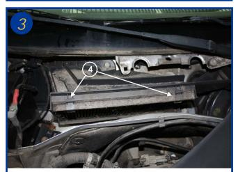
Basculer les 2 clips de maintien du filtre en place (4), et extraire le filtre usagé.
