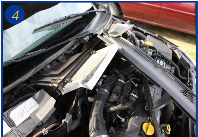
Sortir le filtre et le remplacer.
