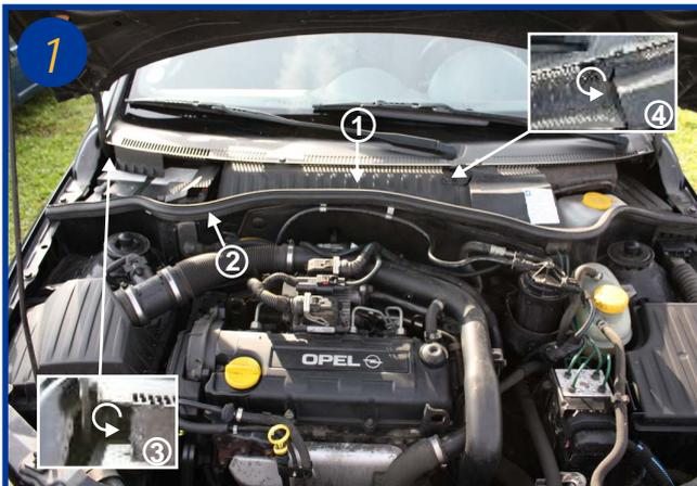
Le filtre d'habitacle est situé sous le capot moteur, au centre devant la baie de pare-brise (1). Retirer sur une grande partie le joint d'étanchéité (2). Dévisser la vis torx T20 (3) puis la vis Torx T20 (4).
