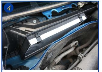
Replacer dans son logement un filtre neuf et basculer les 2 fermoirs.
