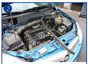
Retirer sur un peu plus de la moitié le joint d'étanchéité du capot moteur (3).
