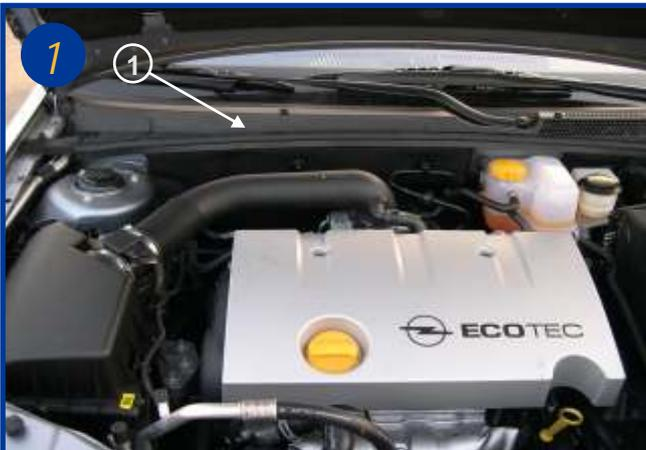
1 L'élément filtrant est situé sous le capot moteur coté passager devant la baie de pare brise (voir flèche 1). Ouvrir le capot moteur.
