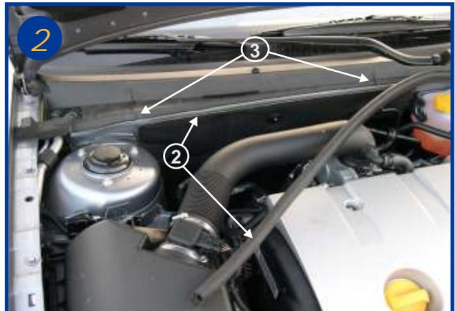
2 Dégager sur la moitié le joint d'étanchéité du compartiment moteur (flèche 2)
