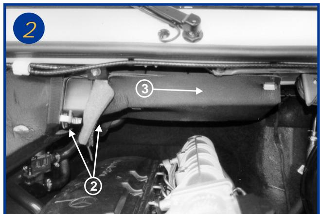
1- Dégrafer le cache plastique sur le conduit afin d'avoir accès aux clips de démontage du couvercle sur le boîtier du filtre d'habitacle (flèche 2).
