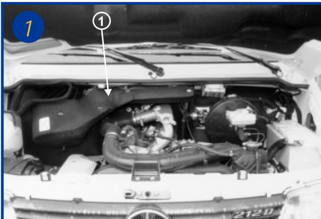
L'élément filtrant est situé sous le capot moteur dans la conduite d'aération sous la baie de pare brise (voir flèche 1).
