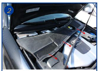
Retirer le carter de protection dans sa totalité en tirant fermement dans le sens des flèches.
