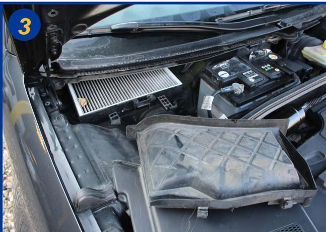
Retirer le couvercle du boîtier filtrant. Retirer l'élément filtrant usagé de son logement, nettoyer le fond du boîtier pour éliminer toutes les impuretés.
