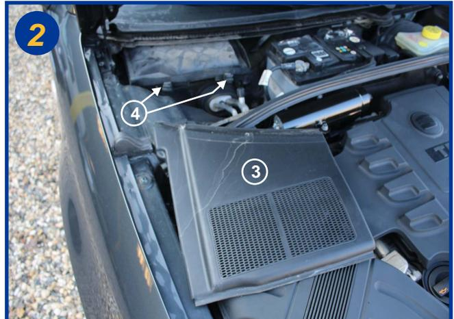
Dégager le carter plastique (3), il suffit juste de tirer dessus pour l'extraire. Ouvrir le boîtier filtrant en basculant les 2 fermoirs (4).
