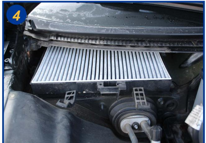
Remplacer l'élément filtrant. Le remontage s'effectue dans l'ordre inverse du démontage.
