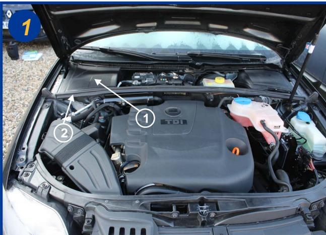
Le filtre d'habitacle est situé sous le capot moteur, côté passager devant la baie de pare-brise (1). Retirer une partie du joint d'étanchéité (2).
