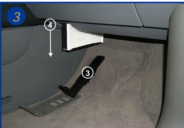
Retirer le couvercle du boîtier filtrant (3) et extraire l'élément filtrant en le tirant vers le bas (flèche 4). Le remontage s'effectue dans l'ordre inverse du démontage.
