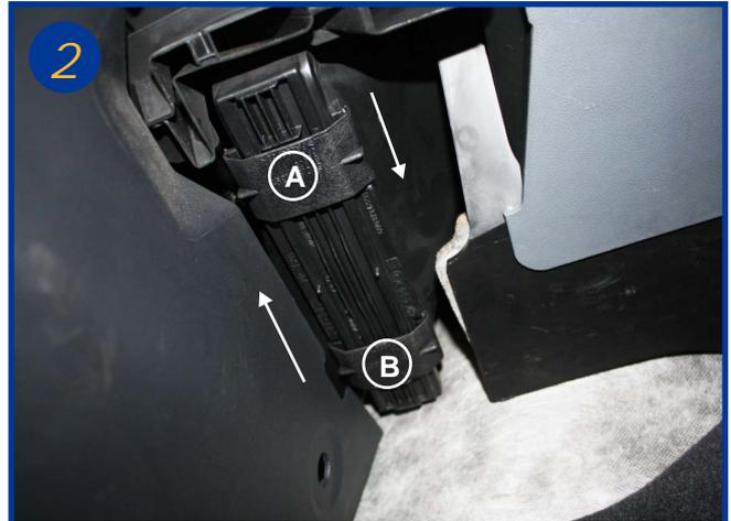
Faire coulisser A et B vers le milieu du couvercle dans le sens des flèches, retirer le couvercle en le faisant pivoter sur le devant.
