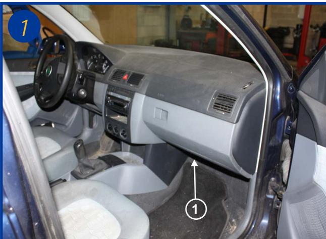
Le filtre d'habitacle est situé à l'intérieur du véhicule, côté passager sous la boîte à gants (1).
