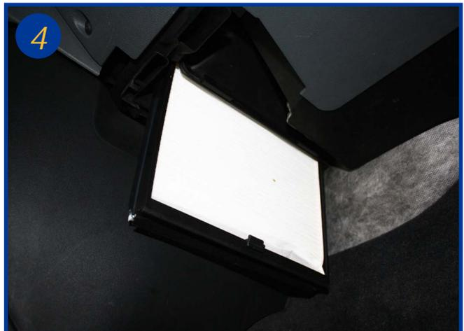
Replacer un nouvel élément dans son cadre en imbriquant les 2 premiers plis à chaque extrémité dans les nervures prévues à cet effet. Le remontage s'effectue dans l'ordre inverse du démontage.
