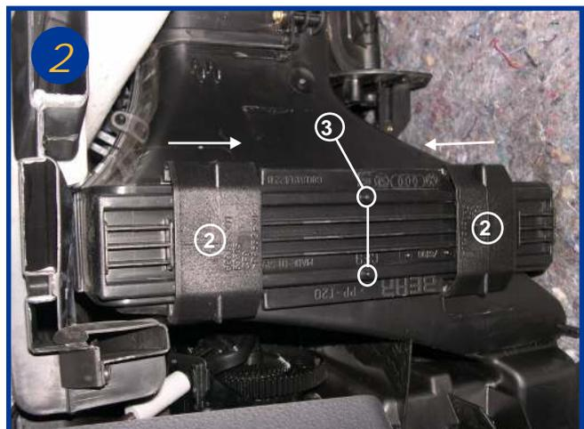
Actionner dans le sens des flèches les 2 coulisseaux (2), jusqu'aux tétons (repère 3).
