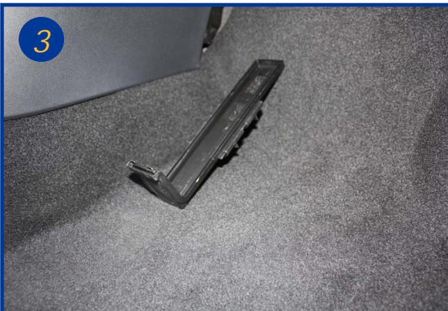
Déposer le couvercle du boîtier filtrant.
