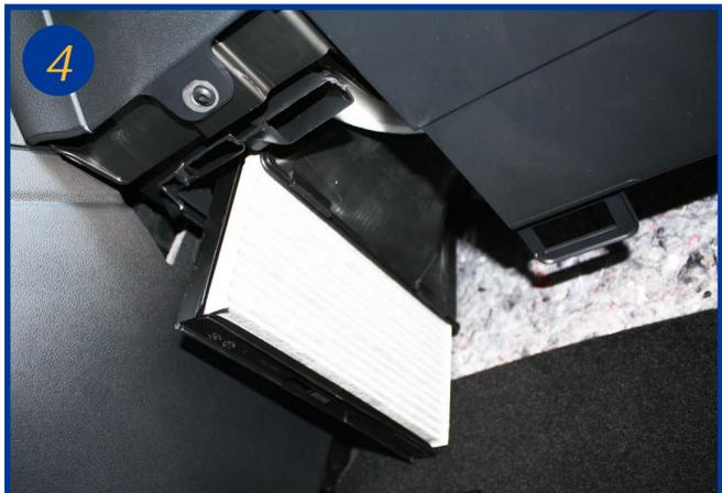
Extraire l'élément filtrant et son cadre, le dissocier du cadre et le remplacer.
