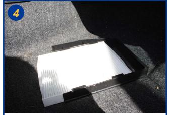
Retirer I 'élément du cadre amovible et le remplacer, en le faisant coulisser dans le sens de la flèche. Le remontage s 'effectue dans I 'ordre inverse du démontage.
