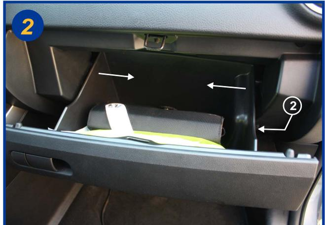
Sur la partie droite (2) désaccoupler l'amortisseur de descente de tiroir. Presser fortement sur les flancs du tiroir dans le sens des flèches pour dégager les butées arrêtoirs.
