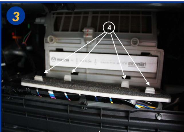
Retirer le couvercle du boîtier filtrant, les quatre ergots (4) servent à le maintenir en place.
