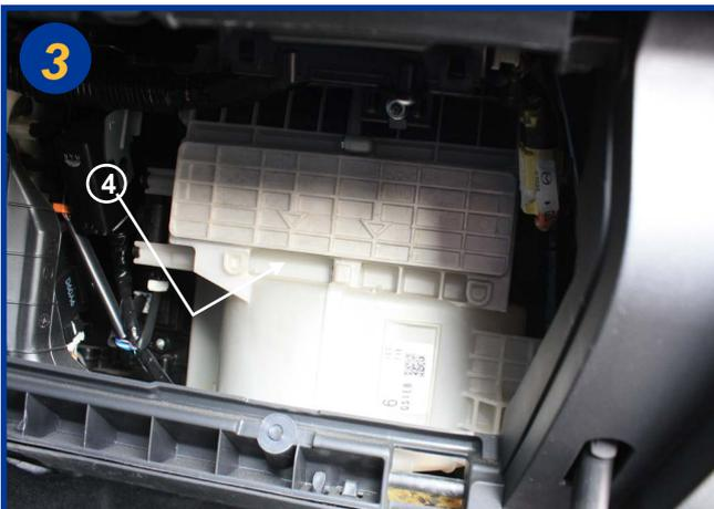
Ouvrir le boîtier filtrant en tirant sur celui-ci au niveau des flèches (4). Extraire le couvercle.
