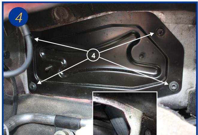
Ensuite, le démontage est identique pour les 2 cotés, dévisser les 4 vis T30 qui fixe la plaque métallique (4). Extraire le filtre (voir encadré). Répéter la même opération sur le côté gauche. Le remontage s'effectue dans l'ordre inverse du démontage.
