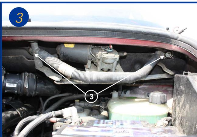
A droite il est nécessaire de démonter le moteur d'essuie-glace pour accéder à la trappe. Le moteur est fixé par 6 vis (2 pour les articulations-(3)), 2 derrière et 2 devant. Dévisser ensuite les 2 écrous plastiques pour retirer le cache en feutre.
