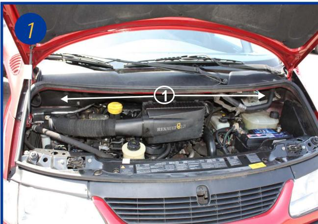
Les 2 éléments filtrants sont situés sous le capot moteur de chaque côté du pare brise au niveau des rétroviseurs extérieurs. (1)
