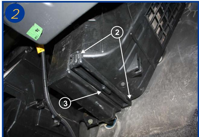
Actionner les deux fermetures en plastique du couvercle sur le boîtier de l'élément filtrant (2) et tirer sur la poignée (3) pour retirer le couvercle.
