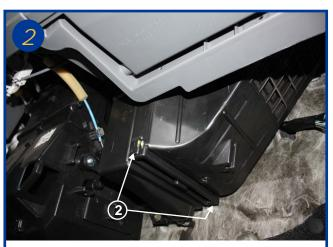
Rabattre les 2 pattes (2) aux 2 extrémités du couvercle du boîtier filtrant et le retirer.
