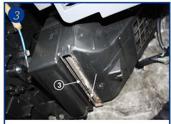
Retirer I 'élément filtrant usagé en le faisant descendre vers le bas (3) comme I 'indique la flèche.
