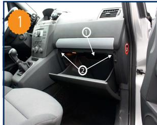
Le filtre d'habitacle est situé à l'intérieur du véhicule coté passager, derrière la boîte à gants (1). Ouvrir celle-ci et dévisser les 2 vis torx (T20) (2).
