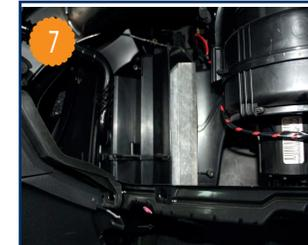
Retirer ce couvercle, l'élément filtrant est alors accessible.
