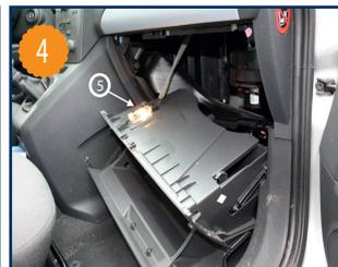
Extraire le bloc boîte à gants dans sa totalité en débranchant la lampe plafonnier de la boîte à gants (5).
