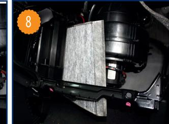
Extraire l'élément filtrant usagé et procéder à son remplacement, imbriquer les 2 premiers plis dans les nervures sur le boîtier (5). Le remontage
