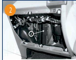
Retirer les 8 clips métalliques de fixation du couvercle en plastique sur le boîtier de l'élément filtrant (voir flèche 2)
