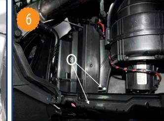
Dévisser ensuite le 2 vis à tête hexagonale (5,5 mm) (8) de fixation du couvercle du boîtier filtrant. La deuxième vis se trouve derrière la barre renfort.
