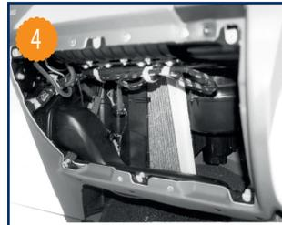
Puis vers le fond afin de le dégager de ses rainures Remplacer le en évitant d'abîmer le joint en mousse autour de l'élément. Le remontage s'effectue alors dans l'ordre inverse du démontage
