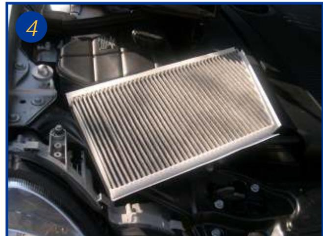
Le nouveau filtre est à replacer comme sur la photo attention de respecter le sens de filtration en positionnant les lèvres d'étanchéité (repère 3) vers le haut, le remontage s'effectue dans l'ordre inverse du démontage.
