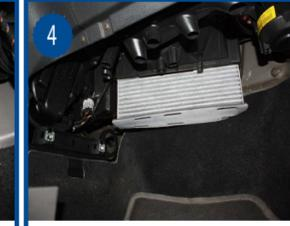
Retirer l'élément filtrant usagé et procéder à son remplacement.
