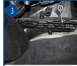
Ouvrir le boîtier filtrant en faisant coulisser le couvercle vers la droite d'environ 2,5 cm pour dégager les ergots à l'aide de la poignée (3).
