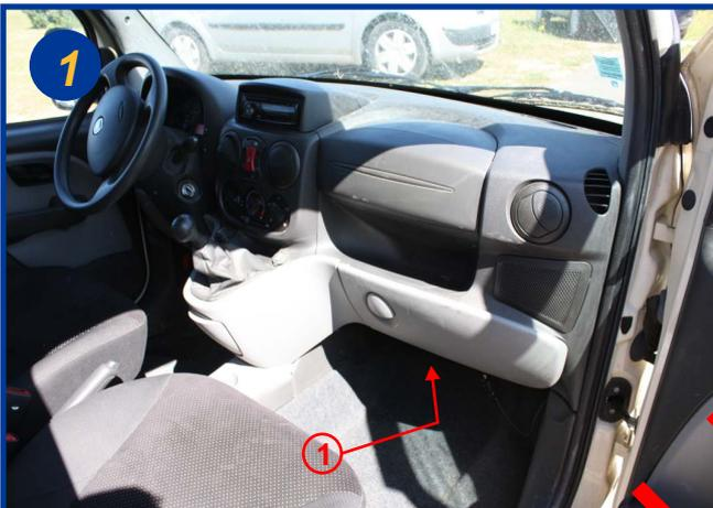
Le filtre d'habitacle est situé à l'intérieur du véhicule, côté passager, sous le tableau de bord (1).
