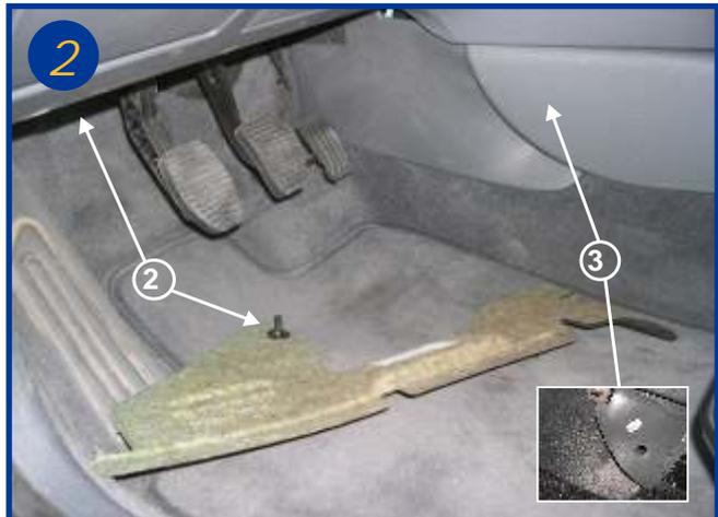
Retirer le cache situé sous le pédalier en déverrouillant la vis de maintien (voir flèche 2). Retirer également le cache qui est parallèle à la console centrale en dévissant la vis qui se trouve derrière ce cache (flèche 3 voir encadré)
