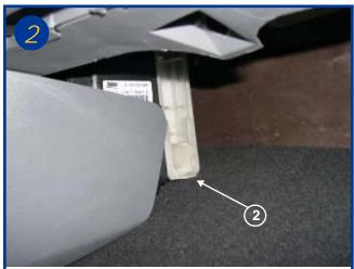
Le filtre d'habitacle est accessible sans aucun démontage, exercez une pression sur le bas du couvercle du boitier grâce à la petite patte, pour ouvrir (repère 2).
