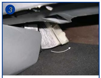
Le filtre est à extraire de la façon suivante, du bas vers le haut en le déformant dans le sens de la flèche.
