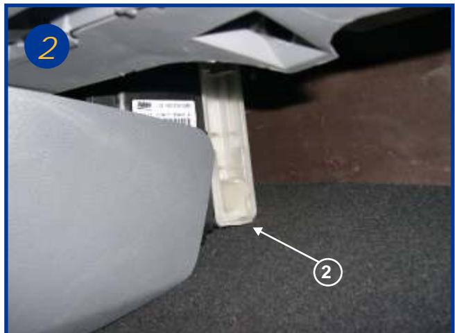
Le filtre d'habitacle est accessible sans aucun démontage, exercez une pression sur le bas du couvercle du boîtier grâce à la petite patte, pour ouvrir (repère 2).
