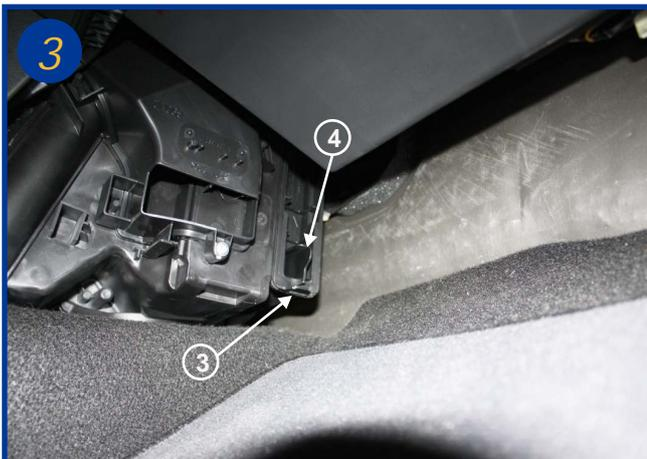
Exercer une pression sur la patte situé à la partie inférieure du couvercle (3) et tirer à l'aide de la poignée (4) pour extraire l'élément filtrant usagé.
