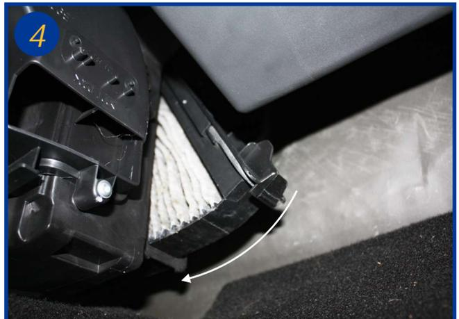
Procéder au remplacement du filtre, ré-introduire le nouvel élément en le déformant pour le faire rentrer (voir flèche).
