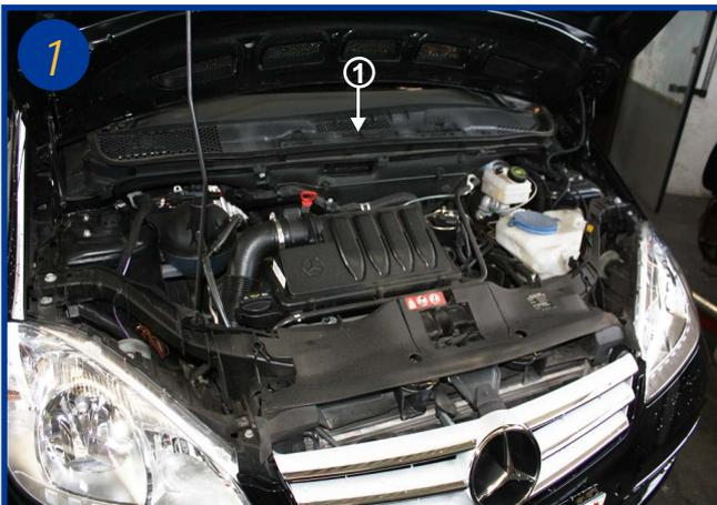
Le filtre d'habitacle est situé sous le capot moteur sur la baie de pare-brise au centre (1).
