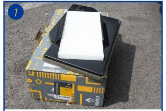
Le montage d'un filtre habitacle sur la Twingo 1 est optionnel chez Renault et dans le cas d'un premier montage, il est nécessaire de se procurer le Kit de montage sous la référence 77 01 409 323, composé d'un boîtier et de son élément.
