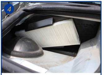
Il ne vous reste plus qu 'à encliqueter l'élément dans son logement. Dans 15 000 kms ou 1 an, l'élément sera juste à remplacer, le cadre restant maintenant partie intégrante du véhicule.
