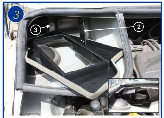
Après avoir retiré l'élément de son cadre, présenter le cadre de la manière que montre la photo, puis le tourner pour que la patte (2) coïncide avec l'emplacement de la vis de 8 située dans le fond du logement (3). Dans l'encadré, le cadre une fois installé.
