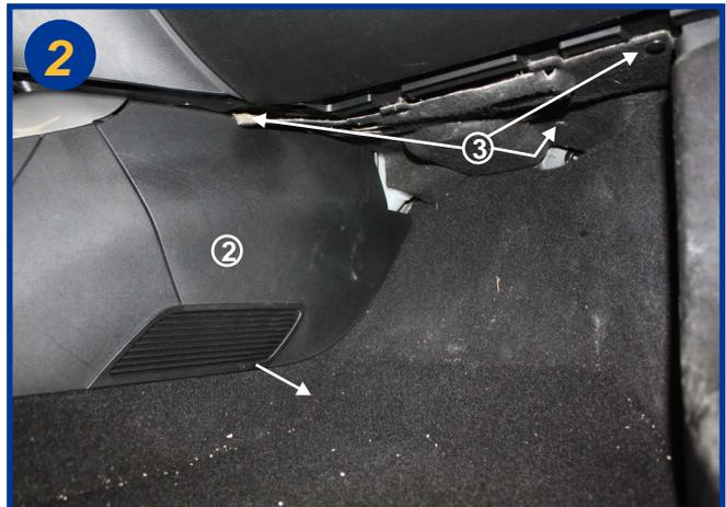
Dégrafer le flanc droit de la console centrale (2) en tirant dans le sens de la flèche. Retirer le flanc. Retirer ensuite les 3 clips plastique (3) pour extraire le carter souple.
