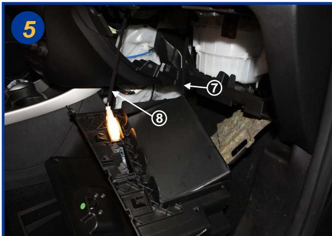
Sortir le bloc boîte à gants, débrancher le contacteur d'ouverture de boîte (7) puis le plafonnier (8). Retirer l'ensemble.
