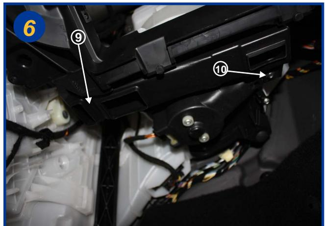
Démonter le conduit de ventilation (9) pour cela dévisser la vis Torx (T25)(10). Retirer le conduit.
