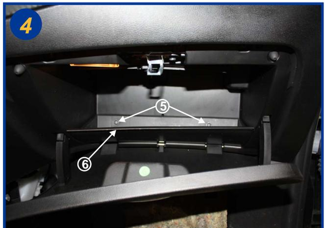
Dévisser les 2 vis cruciformes (5) et retirer la petite tablette plastique (6). Une fois retirée il y a encore 2 vis cruciformes à retirer à gauche et à droite sur les flancs de la boîte à gants.
