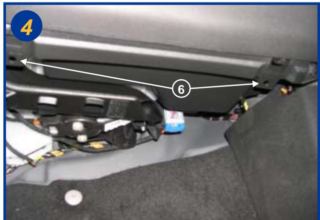
Dévisser les 2 vis Torx (T20) (6) et extraire le bloc boîte à gants en prenant soin de débrancher la connectique de l'airbag.
