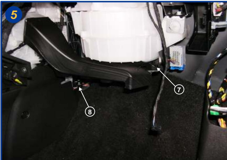
A l'aide d'un tournevis plat, retirer le clips plastique (7). Déboîter le conduit plastique et l'extraire totalement. Ouvrir le boîtier filtrant par le bas (8) et retirer le couvercle en le soulevant légèrement (attention il est fragile dans sa partie supérieure.)
