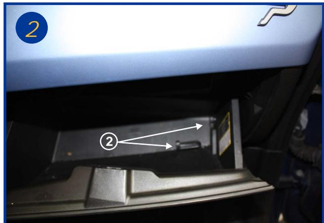
Ouvrir la boîte à gants, à l'aide d'un tournevis chasser la goupille plastique au fond à droite (2).
