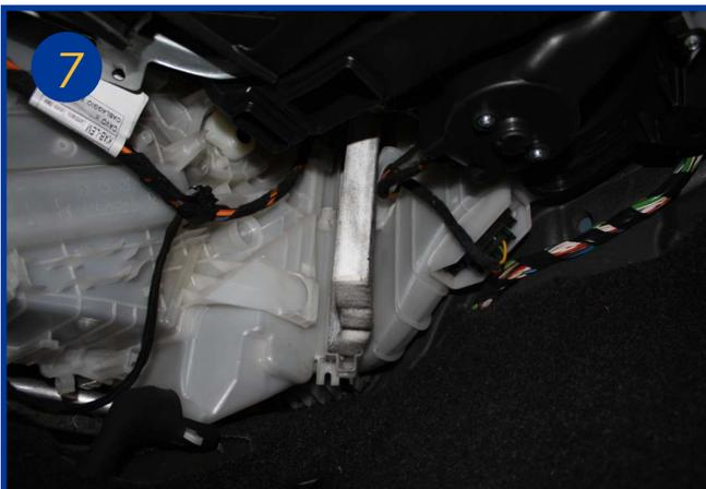
Extraire l'élément filtrant de son boîtier en le déformant.
