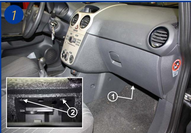
Le filtre d'habitacle est situé à l'intérieur du véhicule, coté passager derrière et sous la boîte à gants (1). Ouvrir la boîte à gants et dévisser les 2 vis Torx (T20)(2) (voir encadré). Refermer la boîte à gants.
