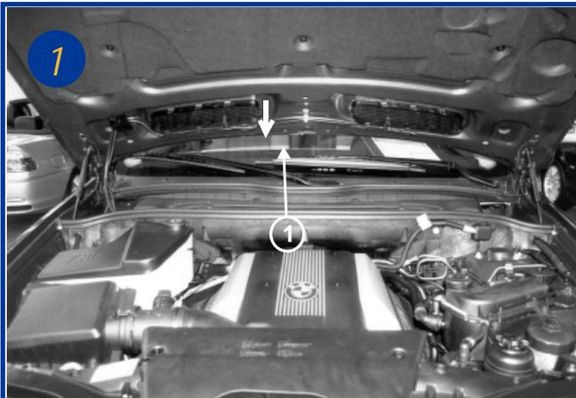
L'élément filtrant est situé sous le capot moteur sous la baie du pare brise au centre
