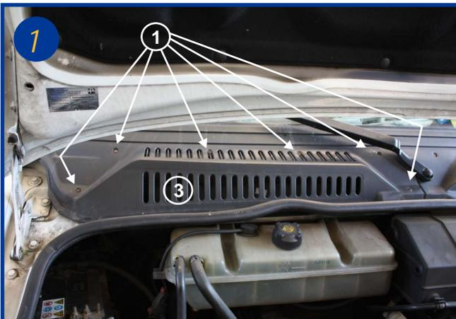
Le filtre d'habitacle est situé sous le capot moteur coté passager. Ouvrir le capot moteur et dévisser les 6 vis torx (1).
