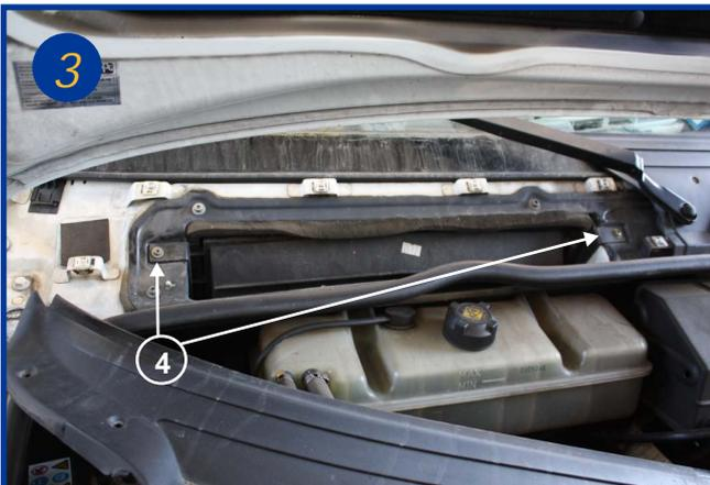
Dévisser ensuite les 2 vis cruciforme qui maintiennent le bloc filtrant en place (4) et le retirer.
