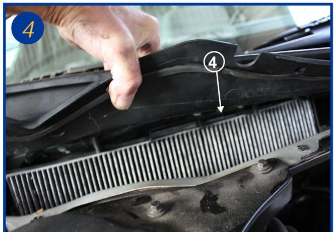
Soulever la demi-grille d'aération et la maintenir soulevé (il est possible de placer une cale pour le maintenir ouvert) puis actionner le loquet (4) afin de dégager l'élément filtrant. Remonter le filtre neuf dans son cadre et rabaisser le loquet. Le remontage s'effectue dans l'ordre inverse du démontage.
