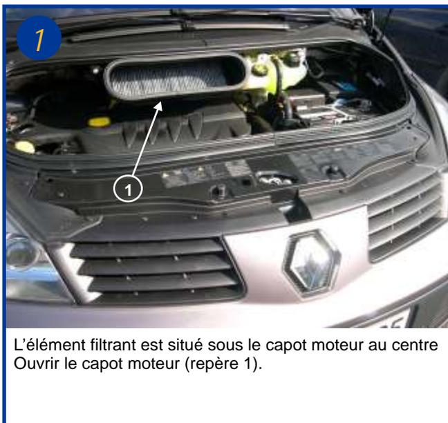
L'élément filtrant est situé sous le capot moteur au centre
