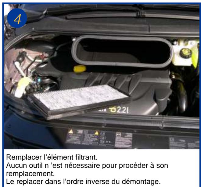
Remplacer l'élément filtrant.
