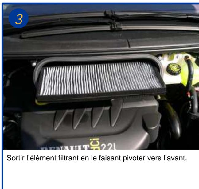
Sortir l'élément filtrant en le faisant pivoter vers l'avant.
