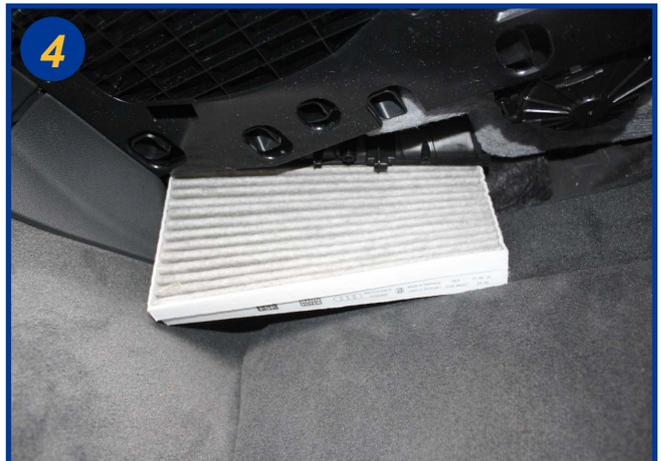
Extraire l'élément filtrant usagé vers le bas, procéder à son remplacement. Le remontage s'effectue dans l'ordre inverse du démontage.
