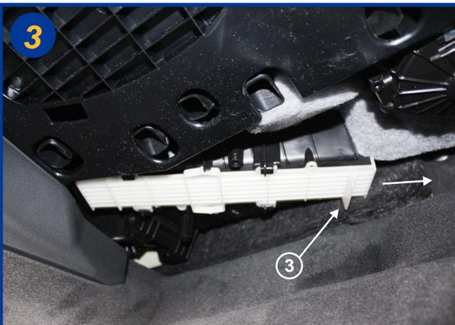
Ouvrir le boîtier filtrant en faisant coulisser le couvercle blanc vers la droite à l'aide de la poignée (3). Retirer le couvercle.
