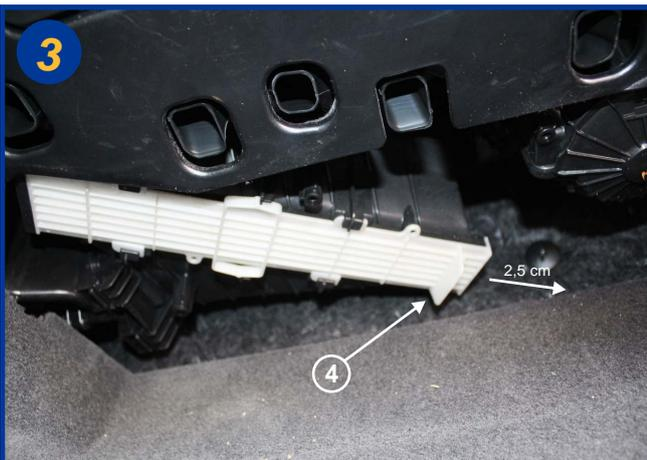
Ouvrir le boîtier filtrant en couissant celui-ci d'environ 2,5 cm vers la droite, en s'aidant de la poignée (4). Retirer totalement le couvercle.
