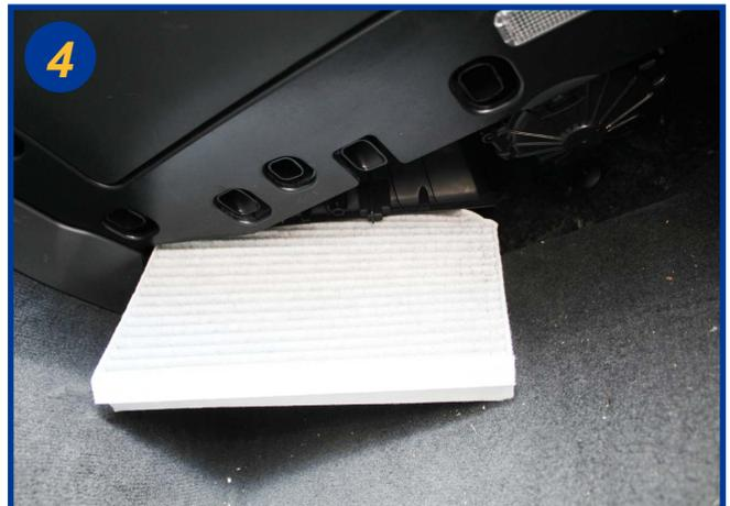
Glisser l'élément filtrant usagé vers le bas et procéder à son remplacement. Le remontage s'effectue dans l'ordre inverse du démontage.
