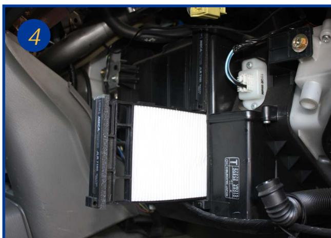
Procéder au remplacement des filtres en les retirant l'un après l'autre.
