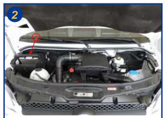
Ouvrir le capot moteur et localiser le boîtier de filtre (2).
