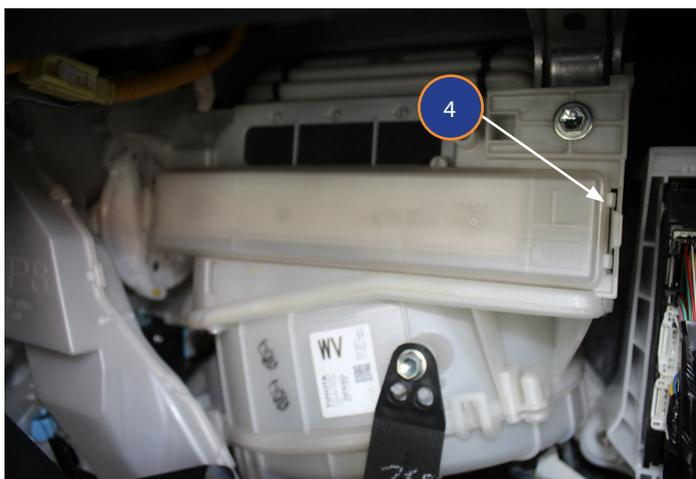
3. Ouvrir le boîtier filtrant en actionnant le loquet de fermeture du couvercle (4) le retirer.
