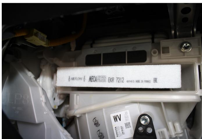
4. Sortir l'élément filtrant usagé du boîtier et le remplacer.
