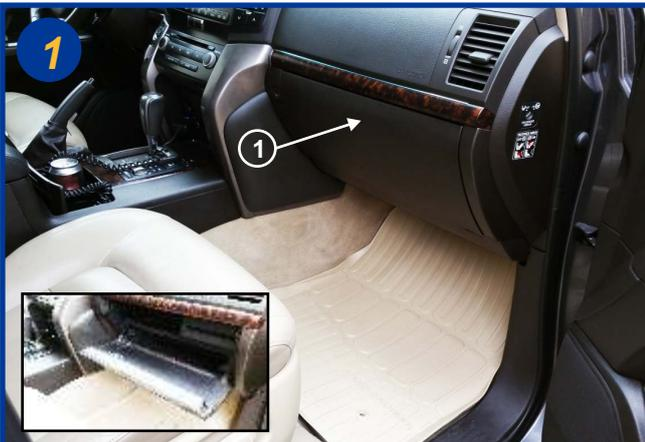
Le filtre d'habitacle est placé à l'intérieur du véhicule, coté passager, accessible dans le fond de la boîte à gants (1).
