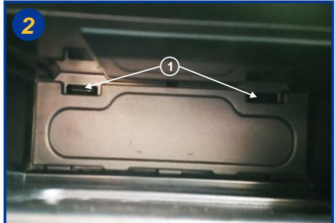
Ouvrir la trappe à l'aide des 2 fermoirs (2) et l'extraire totalement.
