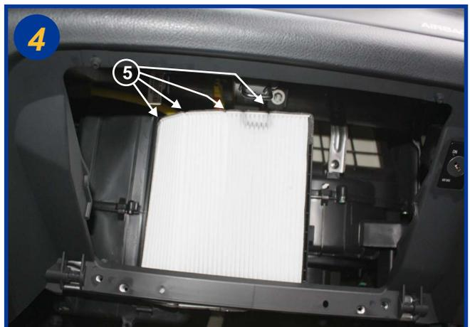
Replacer un filtre neuf en procédant de la même manière qu'au démontage de l'ancien. Des encoches pré-découpées sont prévues pour faciliter (5). Le remontage s'effectue dans l'ordre inverse du démontage.
