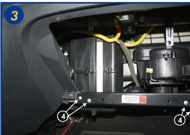
Dévisser la barre de renfort métallique (4 vis cruciformes) (4). Ceci est nécessaire pour extraire le filtre usagé en le pliant à angles droit.
