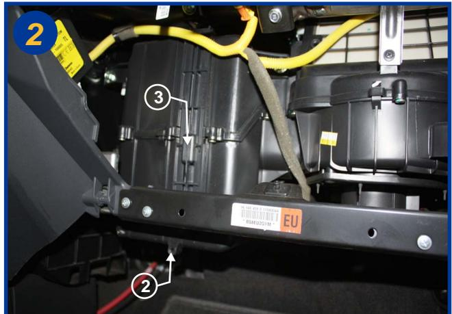
Ouvrir le boîtier filtrant par le dessous (2) puis dégager le couvercle en tirant assez fortement (3). Le sortir par le dessous.
