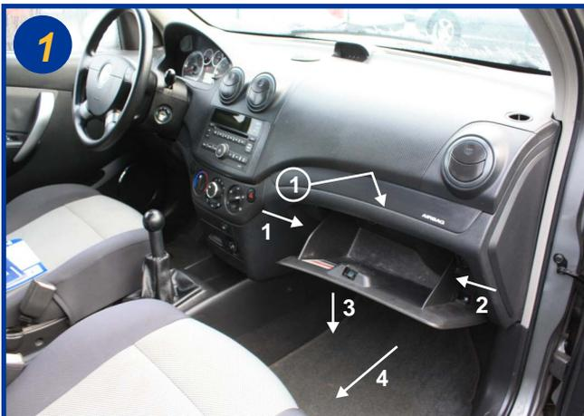
Le filtre d'habitacle est situé à l'intérieur du véhicule, coté passager, derrière la boîte à gants (1). Ouvrir la boîte à gants, presser sur ces flancs pour dégager les arrêtoirs (1-2), basculer celle-ci vers le bas (3) et la retirer de ces charnières (4). (voir flèches).
