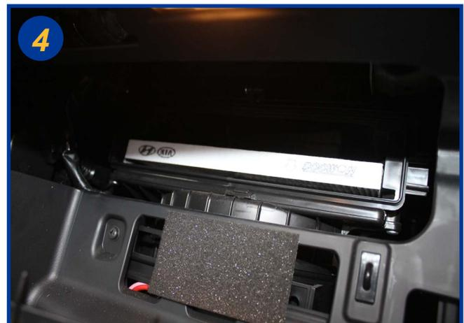
Sortir le filtre usagé du boîtier et le remplacer.
