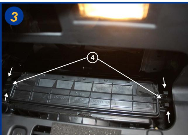
Ouvrir le boîtier filtrant en actionnant les fermoirs (4) dans le sens des flèches et le retirer.
