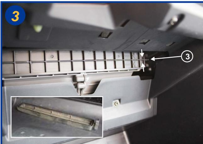
Appuyer sur les pattes du fermoir (3) dans le sens des flèches et retirer le couvercle du boîtier filtrant.
