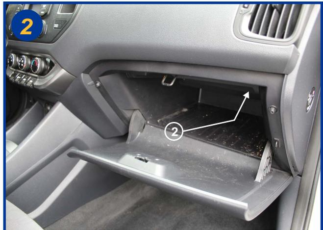
Ouvrir la boîte à gants, le boîtier filtrant est placé dans la partie supérieure dans le sens de la flèche (2).
